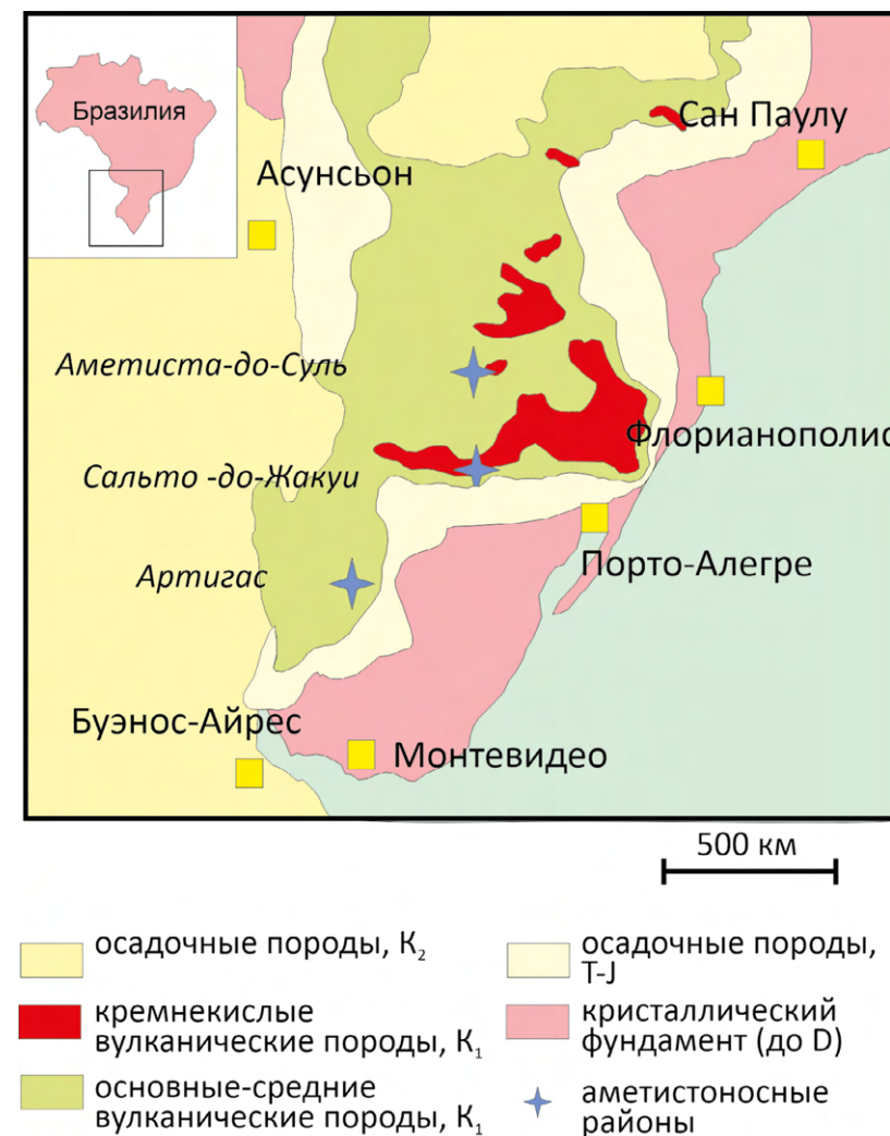
Рис. 153. Схематическая геологическая карта южной части бассейна Параны (по Morteau et al., 2010)
