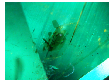
Рис. 118. Включения флогопита в изумруде Малышевского (Мариинского) месторождения. Поле зрения 1 мм. Фото: Синев Д.С.
